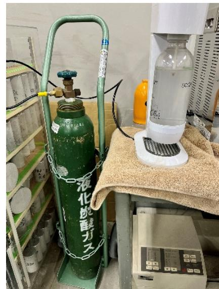
湿式炭酸化処理の例（左図：西岡ら\*の報告、右写真：炭酸水への浸漬）
