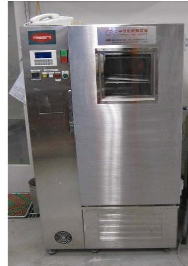
乾式炭酸化処理の例（左図：西岡ら\*の報告、右写真：中性化促進装置）
